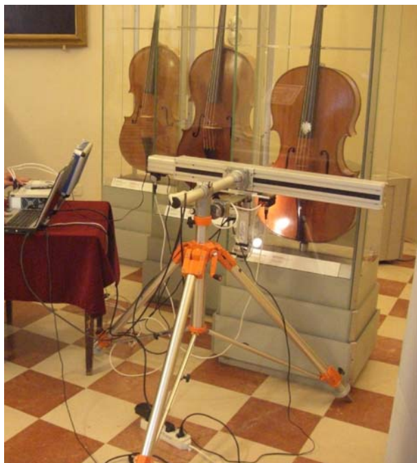
Fig 2. Esempio di lettura dendrocronologica non invasiva.
