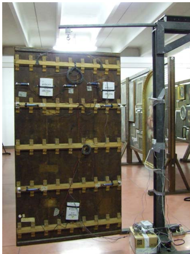
Fig. 9 dipinto su tavola del XVI sec. Retro del dipinto con applicati dispositivi per monitoraggio igroscopico e deformometrico.
